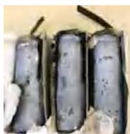
La figure ci-contre à gauche présente l'intérieur d'une pile plate usée de 4,5V. On y découvre trois piles AA L R6, de 1,5V assemblées comme l'indique la figure de droite.
