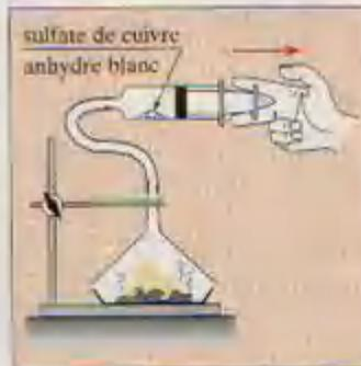
3. Les gaz produits, aspirés dans la seringue, bleussent le sulfate de cuivre anhydre : il y a présence de vapeur d'eau.
