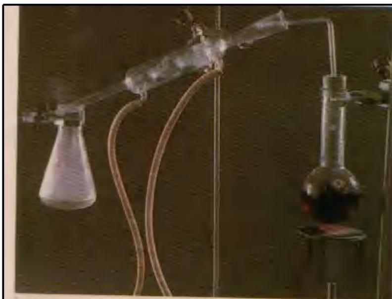
7. Montage de laboratoire pour distiller. Le réfrigérant est un tube à double paroi; l'eau qui y circule refroidit la vapeur qui se condense.
