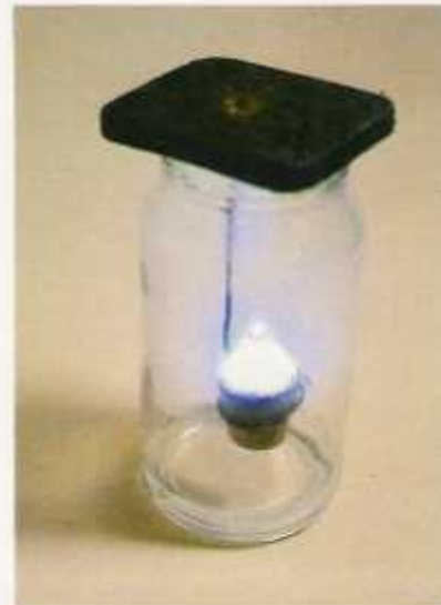
PHOTO 7 Combustion du soufre.
