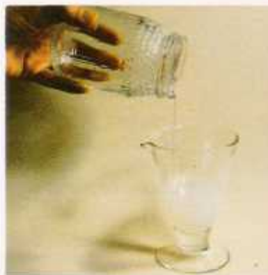
PHOTO 4 Trouble de l'eau de chaux.
